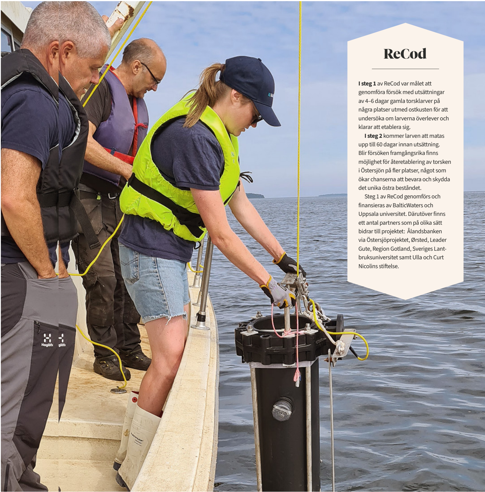
Torsklarverna förs försiktigt ned i utsättningsenheten. Enheten försluts och sänks ned till avsett djup där den öppnas och larverna släpps ut.
